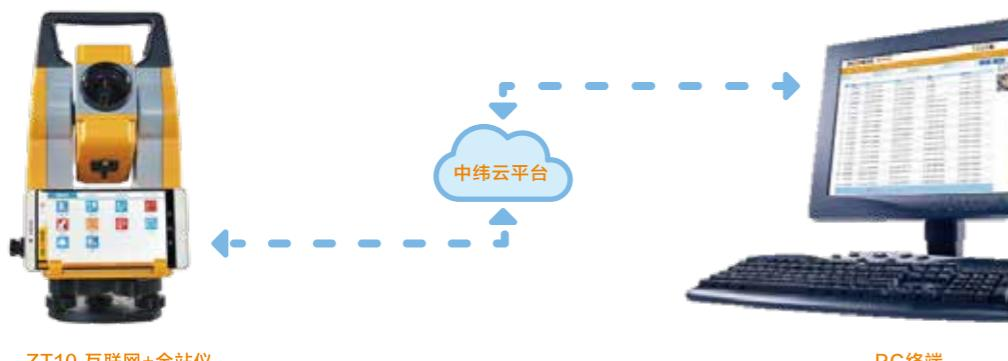
通过ZT10全站仪网络服务功能，配合中纬云平台，实时将测量原始数据发送给监控平台。
