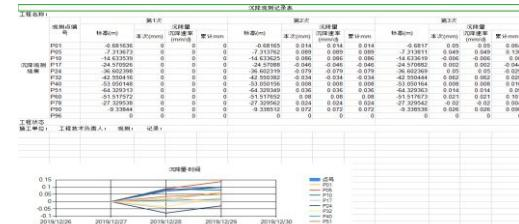
数字水准仪CL-07可以达到二、三级基坑及建筑沉降相关行业规范要求,支持碎部点测量,稳定可靠,可以形成沉降报表及对应的变化曲线图。
